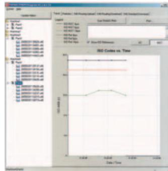
Mit ihrer Trendanalysefunktion rüstet die Software **PAMAS CMDM** die Partikelzähler **PAMAS S40** und **PAMAS SBSS** für die langfristige Zustandsüberwachung von Ölen auf.
