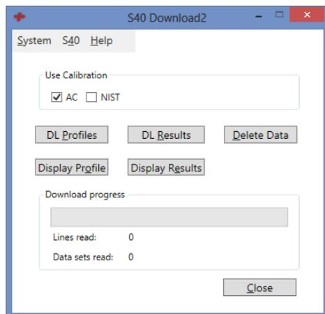
Durch Auswahl der Option AC werden die Messdaten der Kalibrierung gemäß ISO 4402 abgerufen und durch Auswahl der Option NIST die Messungen aus der Kalibrierung nach ISO 11171.
