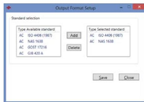
Verfügbare Reinheitsklassenstandards gemäß AC-Kalibrierung (ISO 4402)
