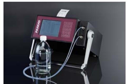
Das tragbare Partikelzählsystem PAMAS S4031 eignet sich für die Analyse von niedrigviskosen Flüssigkeiten wie Wasser oder Wasser-Glykol. Die Kalibrierung erfolgt hierbei gemäß ISO 21501, ISO 11171 oder ISO 4402.
