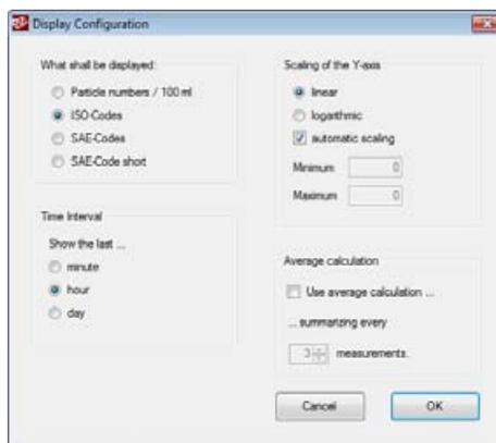
Die Anzeige der Messergebnisse kann voreingestellt werden und an benutzer-spezifische Bedürfnisse angepasst werden. Vier Parameter können konfiguriert werden: Reinheitsklassenstandard, Zeitintervall, Skalierung der Y-Achse, Berechnung des Durchschnittswerts.
