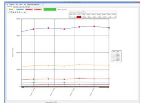
Messwerte, die den minimalen Grenzwert unterschreiten, werden im Diagramm grün markiert. Rot markierte Messwerte haben den maximalen Grenzwert überschritten. Mit dem Button „Stop Save“ wird die Messung unterbrochen und die Messaufzeichnungen werden in eine zuvor definierte Messdatei exportiert.
