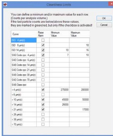
Um den Alarm einzustellen, wird für jeden betreffenden Größenkanal ein minimaler und/oder maximaler Grenzwert definiert. Wenn der Messwert den minimalen Grenzwert unterschreitet bzw. den maximalen Grenzwert überschreitet, dann wird der betreffende Abschnitt im Diagramm grün bzw. rot markiert. Der Alarm wird nur für zuvor definierte Grenzwerte ausgelöst.
