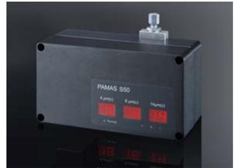
Das Analysesystem PAMAS S50 ist ein Online-Partikelzähler für die Zustandsüberwachung von Hydraulik- und Schmierölen. Auf dem Display des Messgeräts kann der dreistellige Code gemäß ISO 4406 abgelesen werden. Weitere Parameter werden mithilfe der Software PAMAS POV angezeigt. (Foto: PAMAS)
