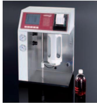
*Der Partikelzähler PAMAS SBSS eignet sich besonders für die Messung von hochviskosen Flüssigkeiten.*
