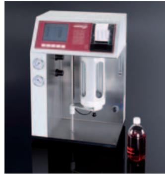
*SVSS est un compteur de particules laboratoire pour les applications pharmaceutiques et autres liquides de faible viscosité. L'appareil de mesure PAMAS SBSS est un compteur de particules pour échantillons de viscosité élevée.*
