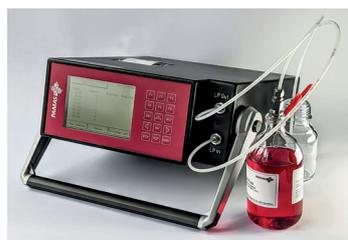
*Für die Probenahme aus Probenflaschen ist das PAMAS S40 AVTUR mit einer Flaschensonde ausgestattet.*
