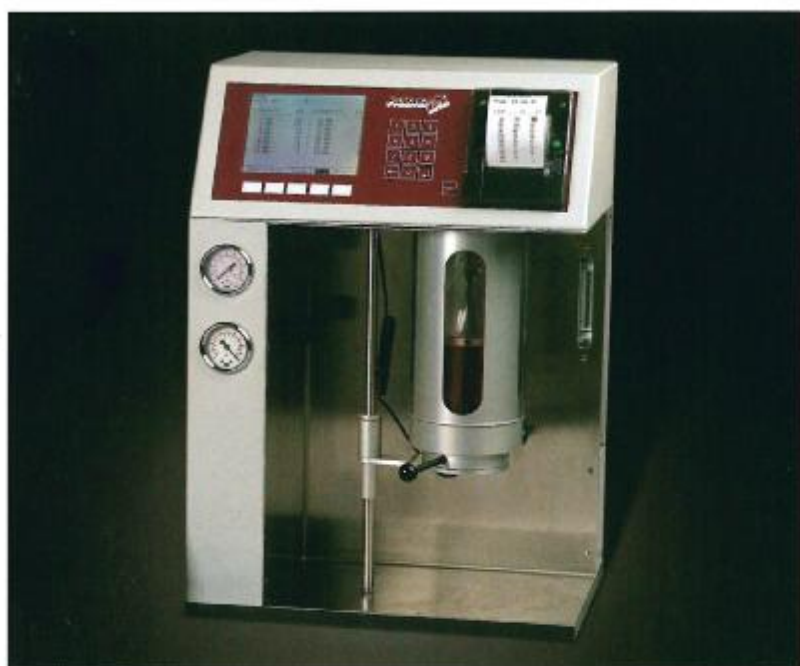
De SBSS is een deeltjesteller die volledig aan alle ISO-normen voldoet en gedacht is voor opstelling in laboratoria (foto: Pamas)
