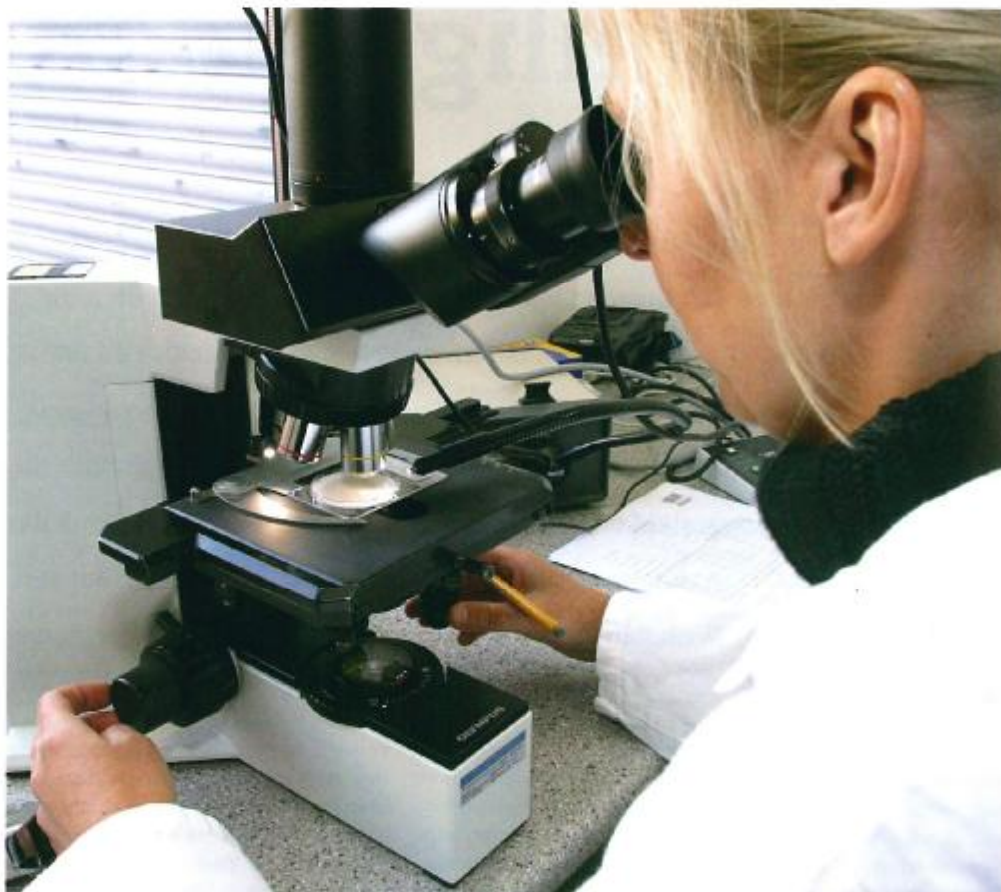
Analyse in het laboratorium geeft niet alleen inzicht in de grootte van deeltjes, maar ook van de aard ervan. Aan de hand hiervan is te bepalen welke componenten in het systeem kennelijk aan slijtage onderhevig zijn (foto: Hitma Filtratie)
