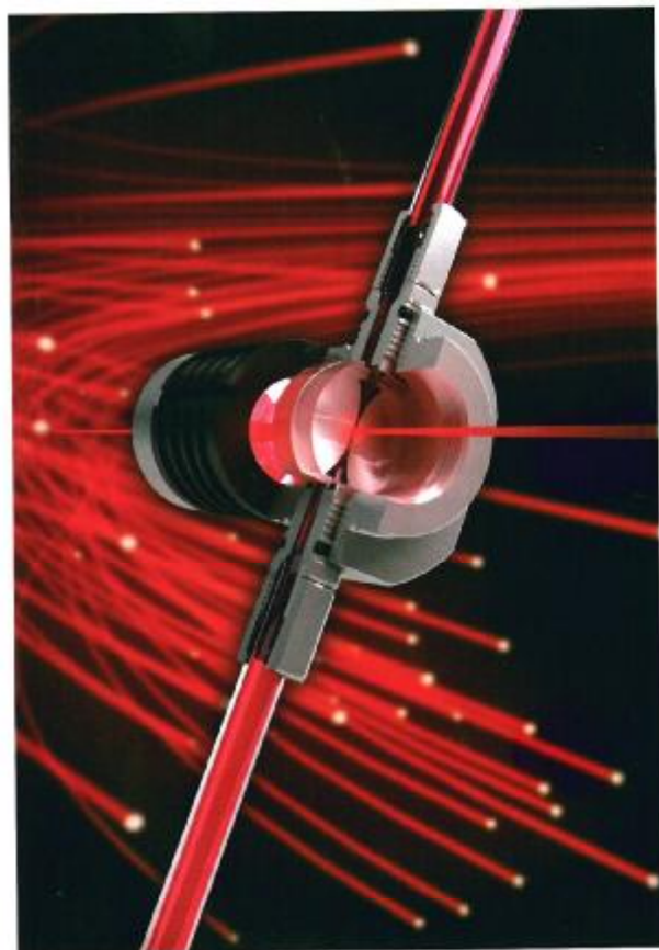
Deeltjestellers voor contaminatiemetingen in hydraulische vloeistoffen werken volgens het principe van lichtblokkade, zoals in ISO 4406 vermeld. Een lichtstraal (steeds vaker een laser) belicht de vloeistofstroom, waarna het licht wordt opgevangen in een fotodetector (foto: Pamas)
